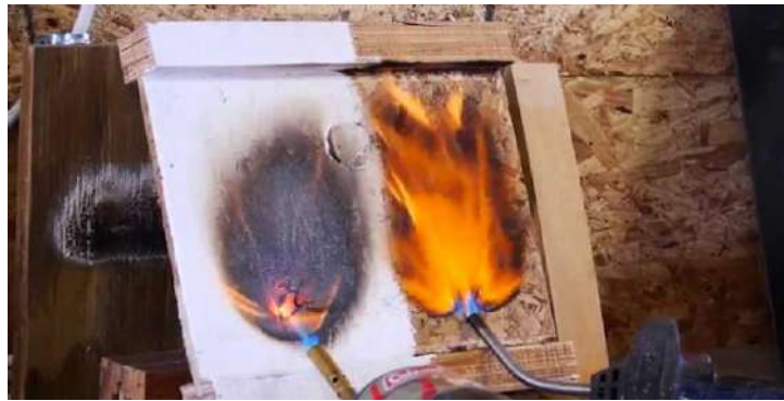
Gambar 5.57 Ilustrasi uji bakar kayu dengan coating anti api (kiri) dan kayu tanpa coating anti api)
